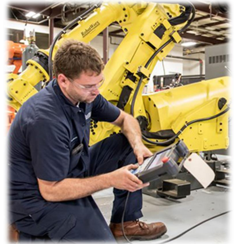
Rys. 1. Programowanie robota z wykorzystaniem Teach Pendant'a [źródło: RobotWorx Blog ]
