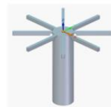
Rys. 3. Model wału obrotowego z łopatkami
