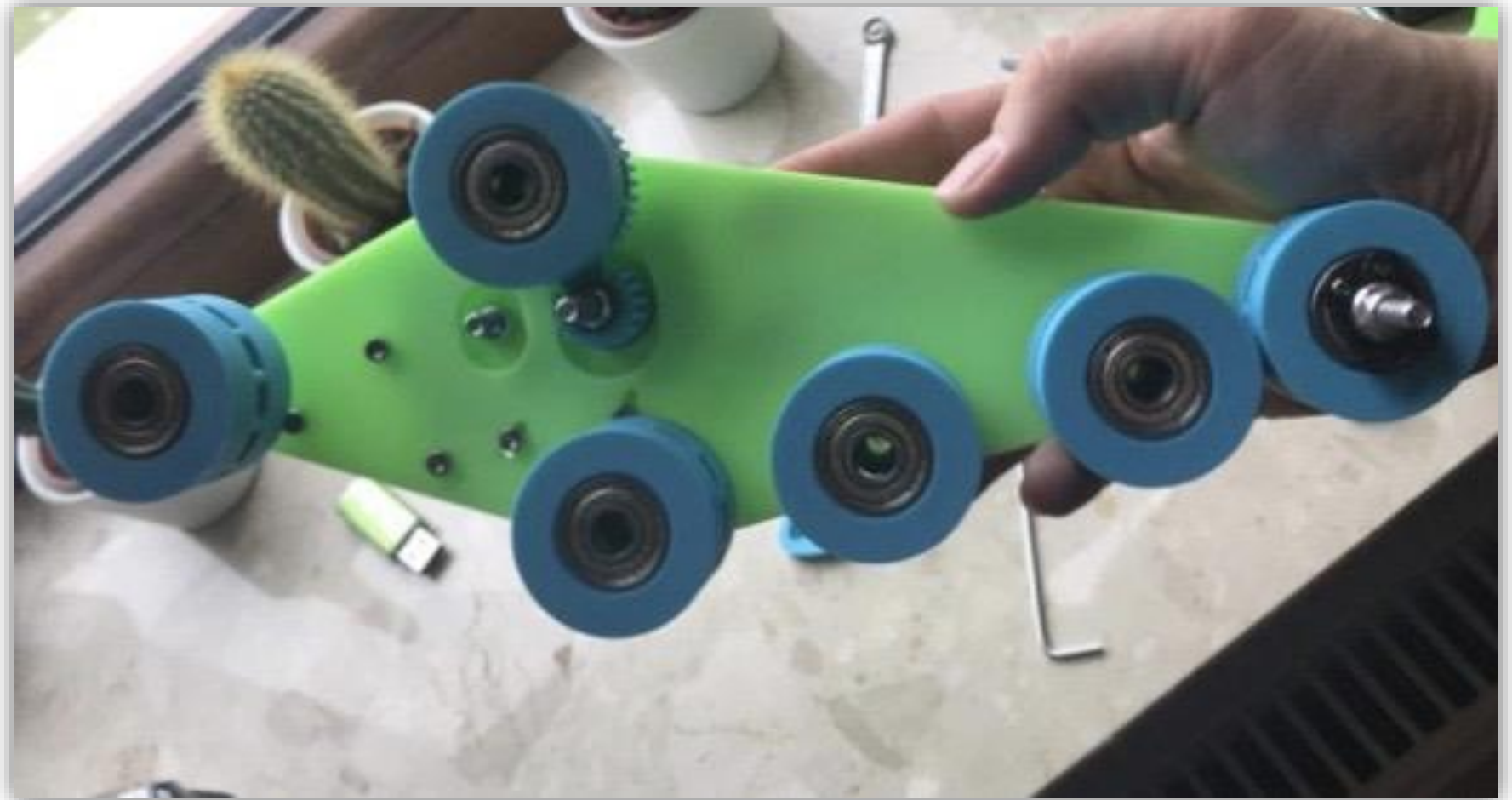
Rys. 10. Montaż kół robota – napędowego, napinającego oraz nośnych.
